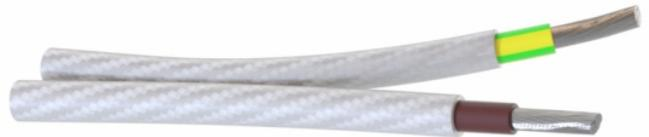
Glasseidenschlauch alkalifrei mit Silikonharz imprägniert. Dauerwärmebeständigkeit bis + 250 °C (Wärmeklasse C); Hochspannungsfest 4.000 V
