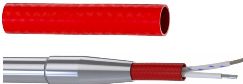
Silikonhochtemperaturschlauch mit Gewebeeinlage, druckbeständig mind. 30 bar (bei 20 °C), Lebensmittelqualität FDA-/BfR-konform, Temperaturbereich – 60 °C bis + 160 °C
